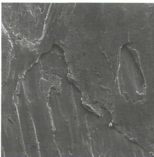
Рис. 3. Развальцовочные язычки, траковые следы, плато на участке стабильного развития трещин шестерни
